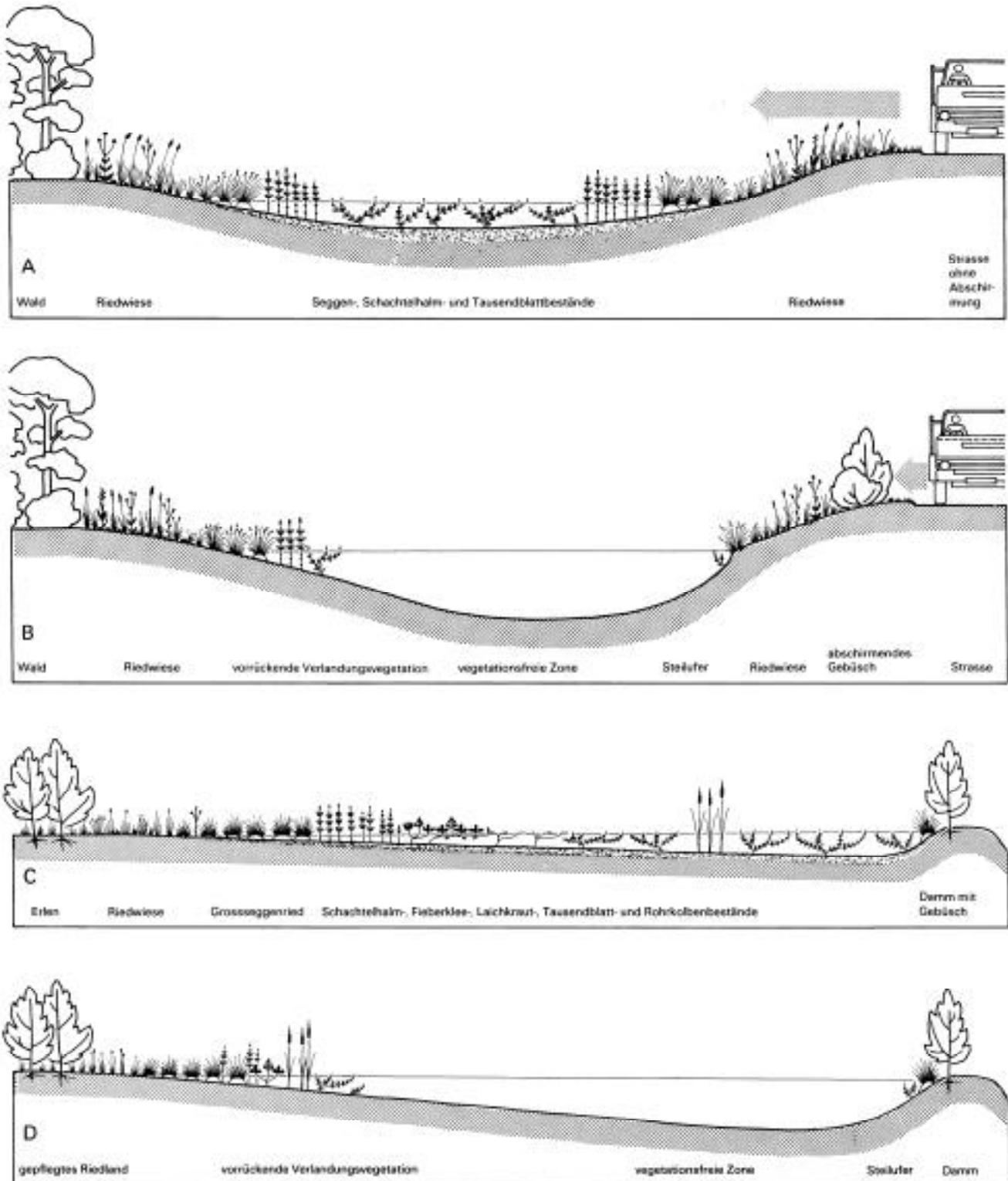
Abb. 30 Stauteich vor und nach der Regeneration. A und C zeigen den Teich im stark verlandeten Zustand. B und D geben die Situation nach der Ausbaggerung wieder. A und B sind Querschnitte. C und D Längsschnitte
